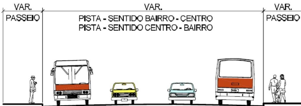
**Figura 2.7.1-2** – Seção existente atualmente com duas faixas por sentido sem canteiro central existente na Estrada de Itapecerica a partir da Av. Carlos Caldeira Filho e na Av. Carlos Lacerda.
